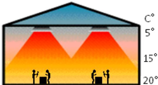
Kod grejanja isijavanjem greje se površina a ne zapremina prostora, što dovodi do energetskih ušteda. Ovim načinom grejanje eliminiše se problem „hladnih nogu“ , nema podizanja prašine i nema opstrujavanje vazduha što utiče na prijatniju radnu atmosferu.
